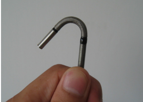
Buigbare tip van de endoscoop
